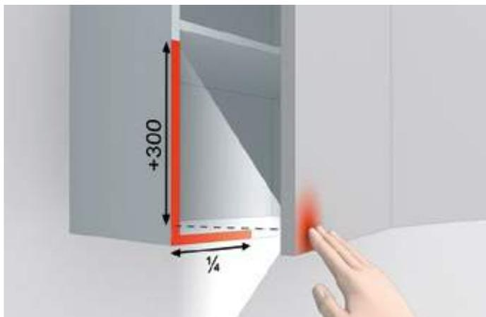
Оптимальное открывание обеспечивается, когда механизм TIP-ON устанавливается в той области, где обычно находится ручка.
