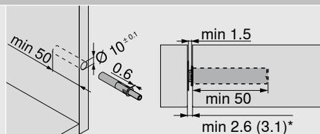
\* Мин. 2.6 мм с пластиной для наклеивания
