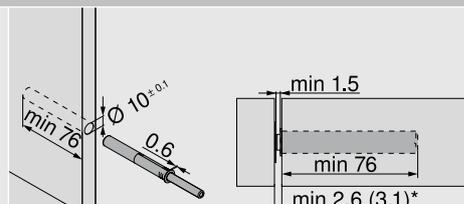
\* Мин. 2.6 мм с пластиной для наклеивания
