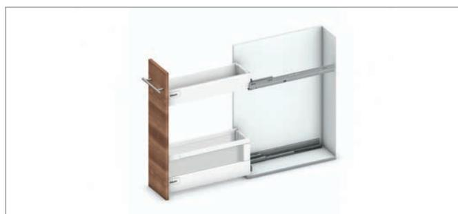
При ширине фасада до 250 мм используются 2 направляющие (устанавливаются диагонально друг другу: правая – сверху, левая – снизу).
